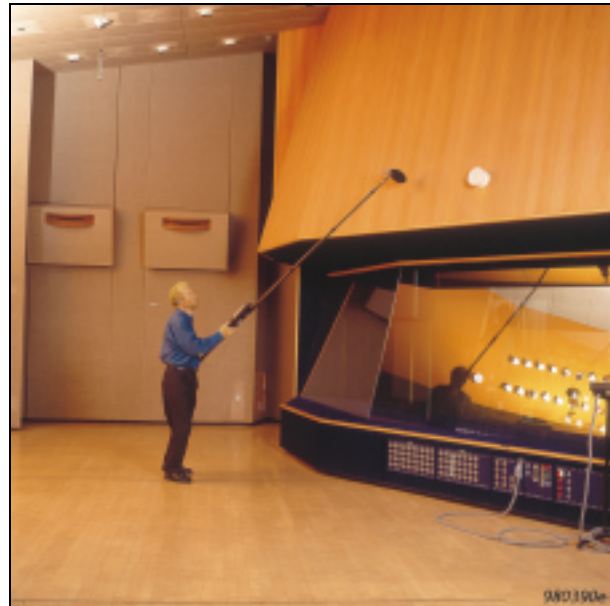
Fig. 10 Cartographie de l'affaiblissement acoustique pour trouver les fuites entre studio et régie d'une salle d'enregistrement
