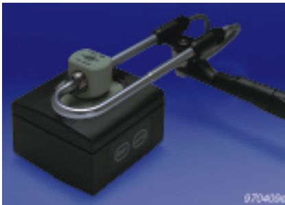
Fig. 6 Calibrage en pression au moyen d'un calibre de sonomètre
